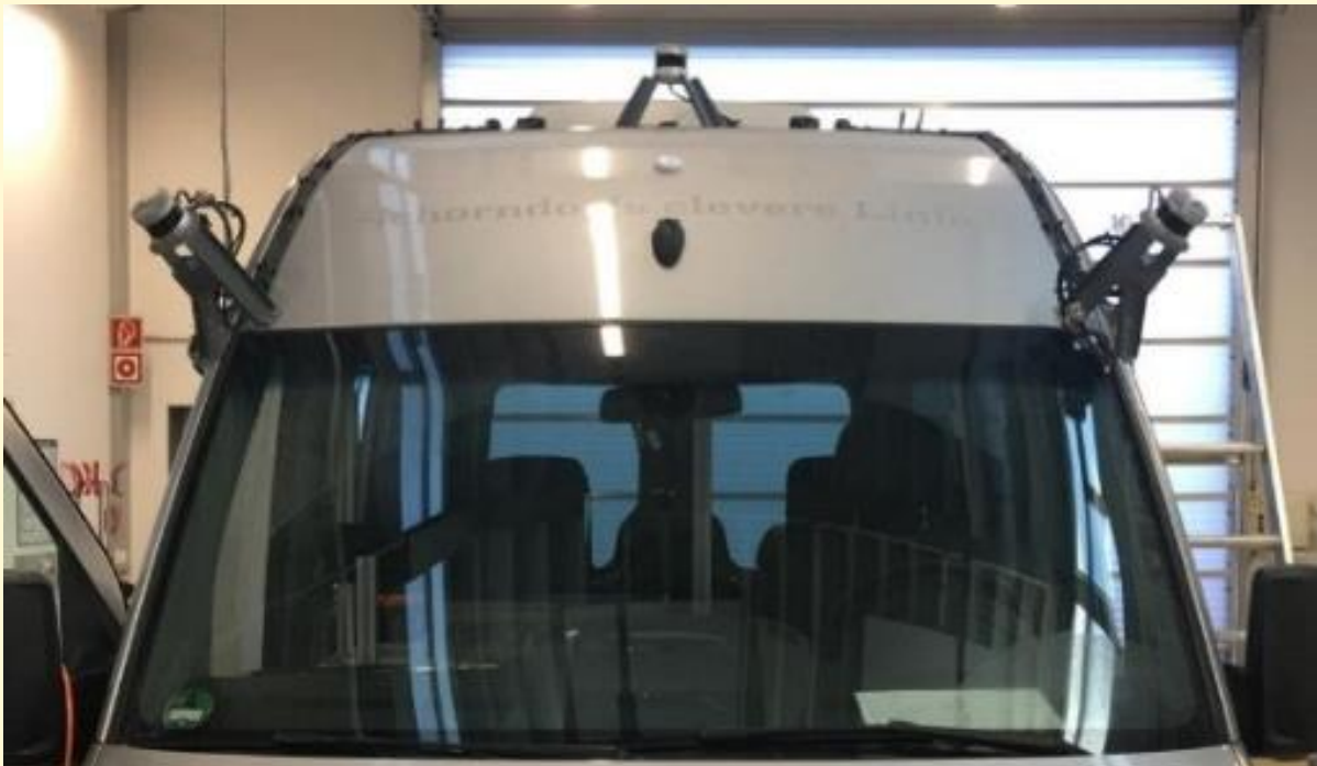
Abbildung 9: Umbau des ehemaligen Bürgerbuses mit zusätzlicher Sensorik
