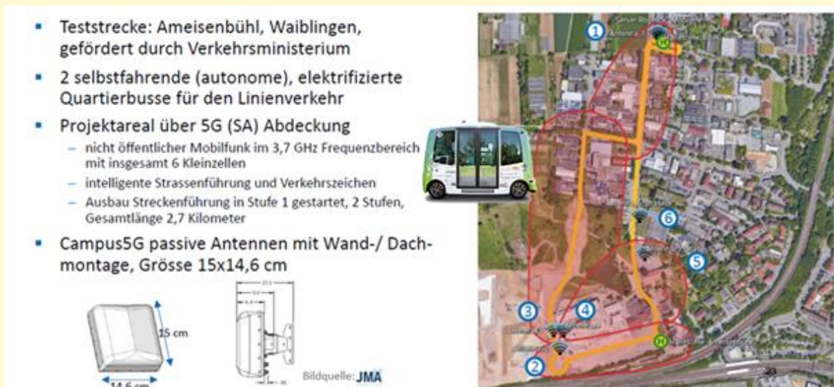
Abbildung 14: Entwicklung und Aufbau eines nicht-öffentlichen Kleinzellen-Netzwerk (5G / WiFi 6) in 2 Stufen
